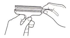
三角形の稜の部分を平面にあてて、その平面とストレート・エッジの間隙を観察することによって平面度の測定を行います。この場合2~3μmの間隙は判定できます。
